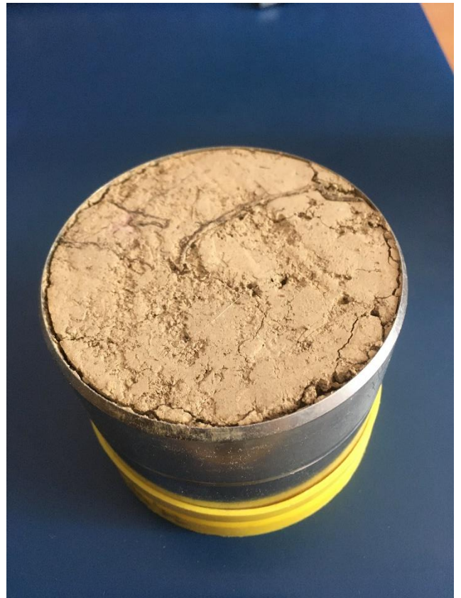
1: Ungestörte Bodenprobe mit Feinwurzeln Oberseite (getrocknet). 2: Feinwurzeln aussortiert aus Mischprobe. 3: Mischprobe separiert nach einzelnen Bestandteilen. 4: Ungestörte Bodenprobe mit Feinwurzeln Unterseite (getrocknet)
